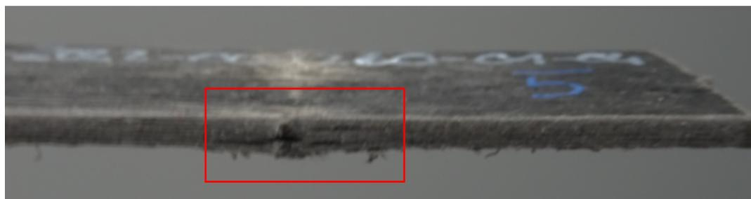
Abbildung 40: Schwarzer Referenzbiegeprüfkörper mit  $0\text{ °}$  GF-Orientierung mit Rissbildung im Prüfkörper
