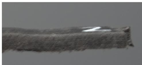
Abbildung 37: Schwarzer GF 70 ILSS-Prüfkörper mit 0° GF-Orientierung
