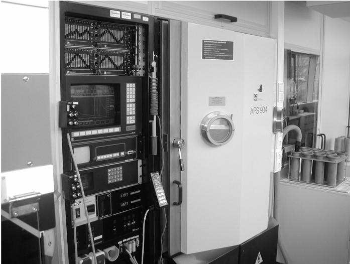
Abb. 17: Vakuumbdampfungsanlage APS 904 (Leybold Optics GmbH)
