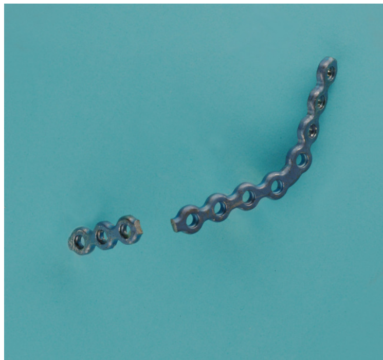
Abb. 41: Frakturierte Rekonstruktionsplatte mit typischer Frakturlokalisierung im Bereich des Plattensteiges
