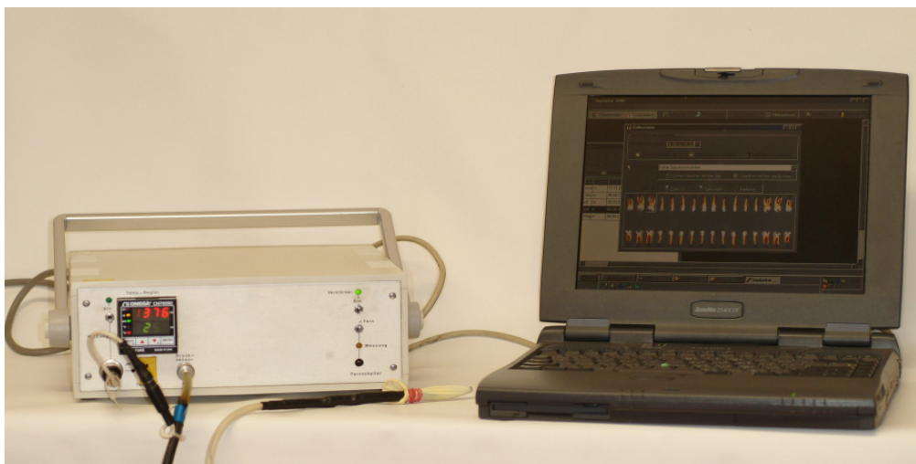
Abb. 8: Computergestützte Kaukraftmessapparatur im messbereiten Zustand
