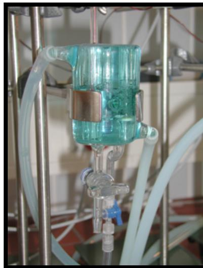
**Abb. 2.3** — Vergrößerte Darstellung der eigentlichen Messkammer. Sie besteht aus einem doppelwandigen Gefäß (Funktion als Wärmekammer) und kann durch eine Gasfritte im Boden kontinuierlich begast werden. Die Gefäße enthielten 10 ml Tyrode-Lösung. Die Temperatur wurde kontinuierlich mit einem Pumpsystem und einem Thermostat auf 37 °C konstant gehalten.
