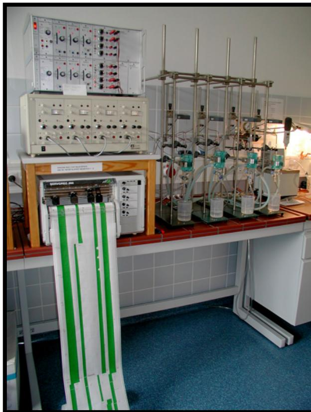
**Abb. 2.2** — Versuchsanordnung zur Erfassung der Kontraktionskraft humaner kardialer Vorhofmuskulatur. Zur schnelleren und effizienteren Versuchsdurchführung sind vier Messeinrichtungen parallel nebeneinander angeordnet. Alle gemessenen Signale in den jeweiligen Apparaturen können durch eigene Messverstärker unterschiedlich stark verstärkt werden.
