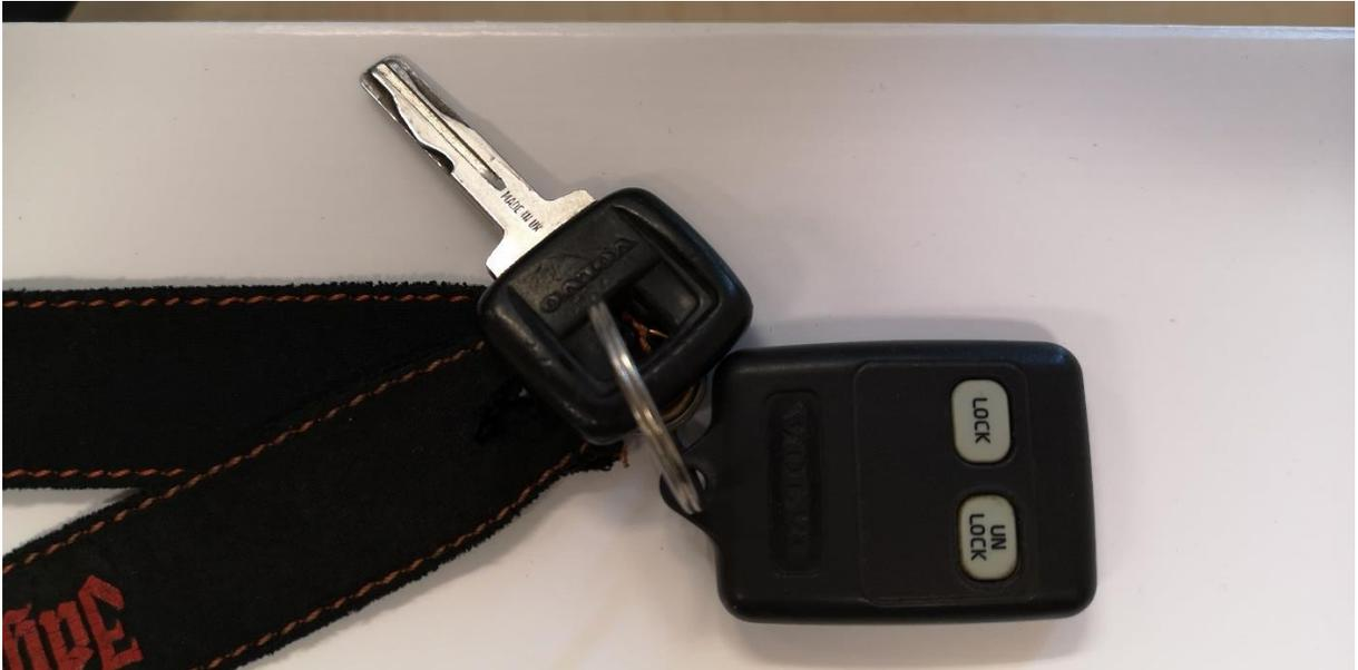
Abbildung 12: beliebiger Autoschlüssel als alternative Emitter-Quelle
